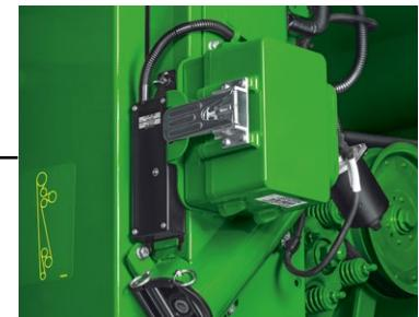
С помощью камеры ActiveVision, установленной в элеваторе чистого зерна, можно контролировать, что поступает в бункер.
