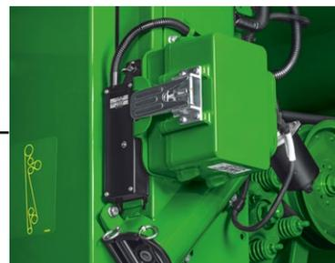
С помощью камеры ActiveVision, установленной в элеваторе чистого зерна, можно контролировать, что поступает в бункер.
