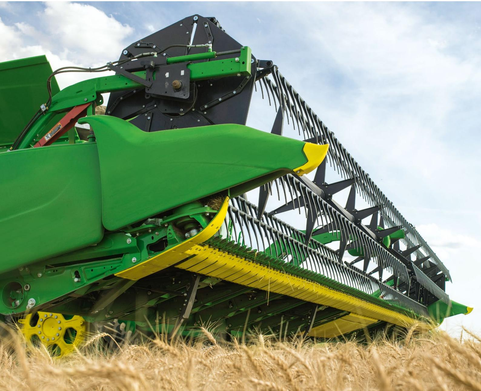
**13,70 М****ШИРИНА ЗАХВАТА****190 ММ****РЕЖУЩИЙ АППАРАТ
