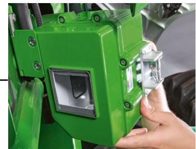
А изображение с высокоскоростной камеры ActiveVision, установленной возле шнека недомолоченных колосьев, позволяет в реальном времени наблюдать за содержимым недомолоченных колосьев и анализировать его.
