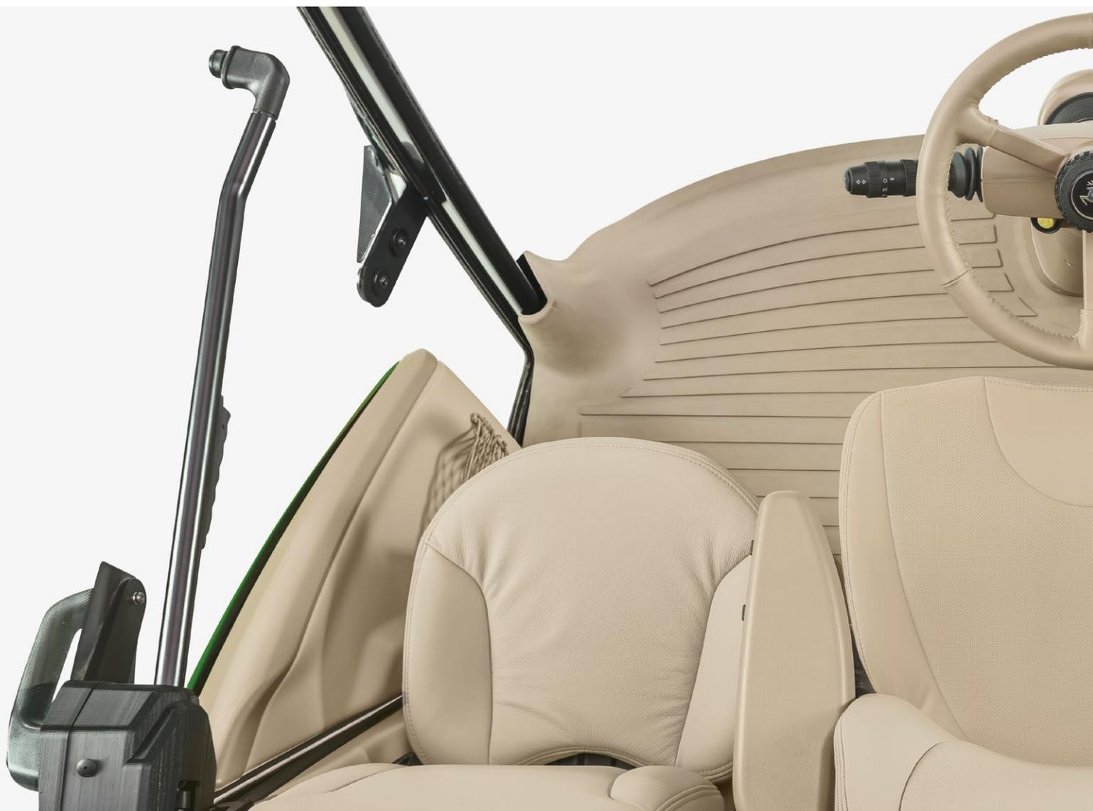
Антибликовое покрытие стекла обеспечивает четкий обзор всех ключевых зон – от концов жатки до наконечника выгрузного шнека. Обеспечить комфорт тоже несложно. Сиденье Super Air Comfort полностью регулируется и оснащено подкладкой для поглощения влаги и поддержания ощущения свежести.
