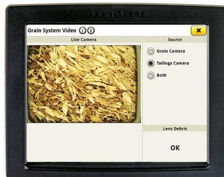
Здесь в реальном времени отображаются результаты работы с камеры для недомолоченных колосьев. Такая оценка гораздо точнее проверки через смотровой люк. Функция подробного анализа позволяет контролировать, например, количество поврежденного зерна, чтобы добиться максимального его качества.
